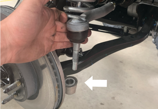
Fig. 2: Tie rod end link.
