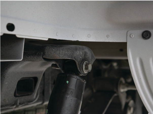
Fig. 16: Remove upper shock mount bolt.
