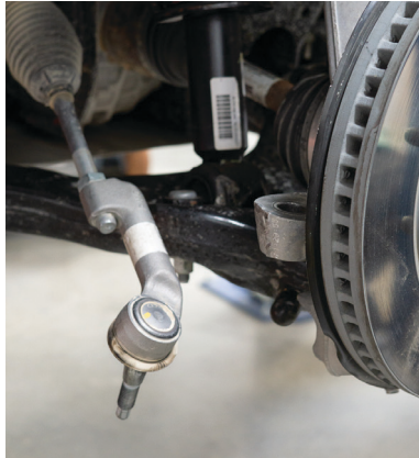
Fig. 2: Tie rod end link.
