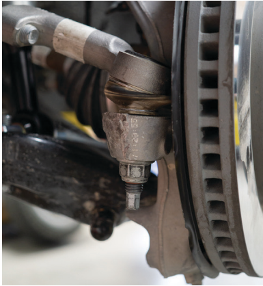
Fig. 13: Tie rod end link.
